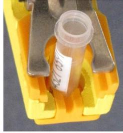
4.2 Fermer la pince délicatement pour encliquer l'aiguille sur le tube, tout en vérifiant leur bon alignement et en les guidant si nécessaire pour ne pas les endommager. Un léger clic retentit, le tube doit être positionné en butée contre la tête d'aiguille. Puis ré-ouvrir les poignées de la pince.
