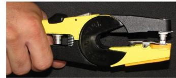
4.3 Appuyer sur le verrou situé sur le côté de la pince et retirer l'ensemble aiguille + tube de la pince.
