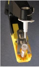
4.1 Placer le tube ③ dans le logement prévu à cet effet dans l'adaptateur de la pince.
